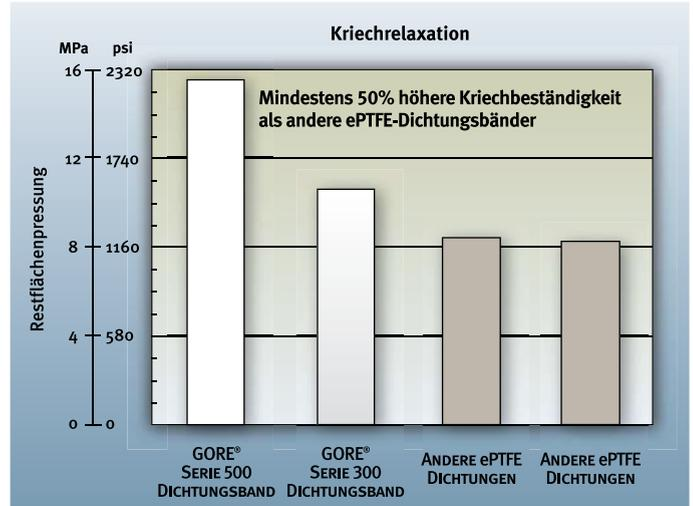
Kriechrelaxation, basierend auf EN13555,  $P_{QR}$  unter Verwendung von 15mm x 3mm Bändern, gelegt zu einem geschlossenen Ring ( $\varnothing 150\text{mm}$ ).  $P_{QR}$ -Werte wurden bei 30MPa und 150°C ermittelt.
